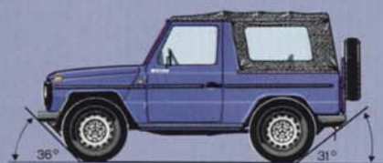
Überhangwinkel 36° vorn, 31° hinten.
