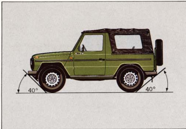
Radstand und Aufbauabmessungen ergeben große Überhangwinkel.
