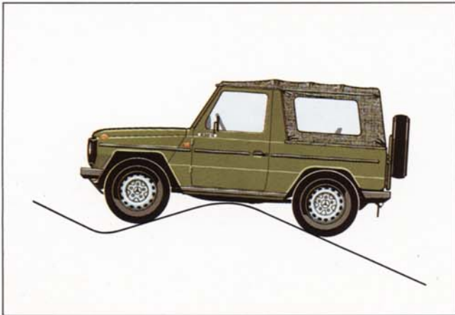
Großer Rampenwinkel: Selbst hohe Bodenwellen sind kein Hindernis.
