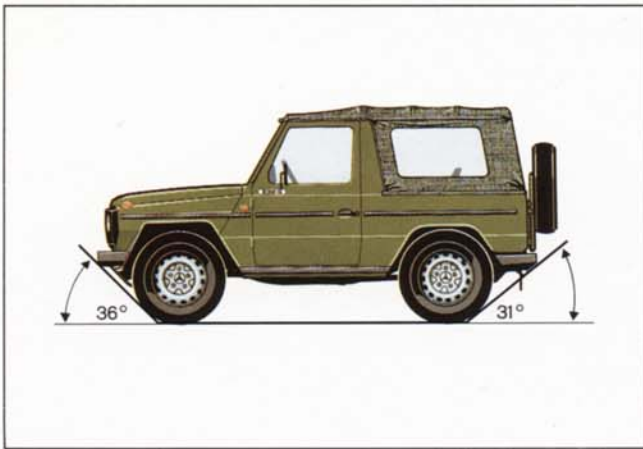
Radstand und Aufbauabmessungen ergeben große Überhangwinkel.
